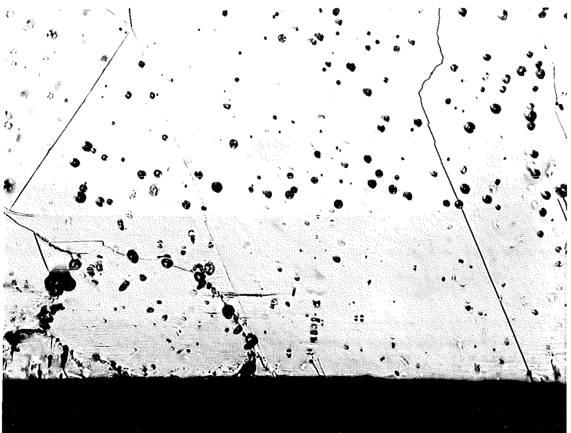
Figuur 36. 4,53 a/o Li. 800 °C. Na 17,5 uur één inw. geox. zone met zichtbare, niet opt. akt. oxyde- partikels. V = 240 X
