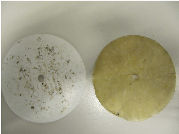
Figuur 6.2: De wrijvingsreductie systemen A (rechts) en B na de proef op het asfaltproefstuk van 80 mm hoog
