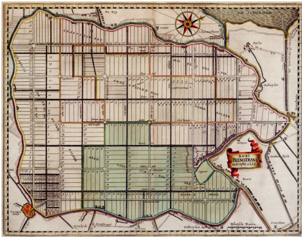
Afbeelding 10.1.6 Landschapsarchitectonische plananalyse van droogmakerij De Beemster op basis van een historische kaart uit de zeventiende eeuw (onder). Een eerste analysestap is het tekenen van een gereduceerde plattegrond, die de functionele indeling van de polder laat zien in landbouwkavels, waterlopen en wegennetwerk (linksboven). In een tweede tekening, een exploded view, ligt de nadruk op de ruimtelijke indeling in lanen en landschapskamers, ruimten die door middel van bomenrijen worden begrensd (rechtsboven). (bron: Kavelkaart van de Beemster, uitgave Claes Jansz. Visscher, 1625; Leupen, Grafe, Körnig, Lampe & De Zeeuw, 1999, pp. 158, 163.)
