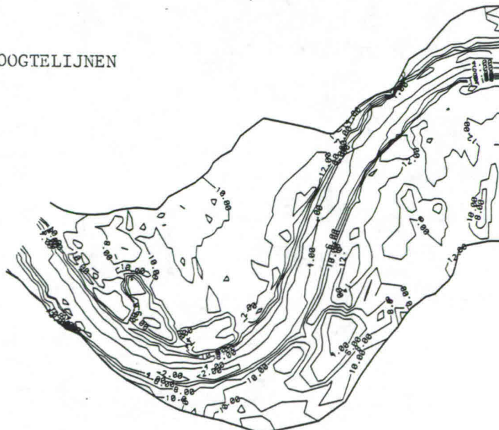
Fig. 3.7A Hoogwaterberekening voor de Waal bij Gendt (model WAQUA)
