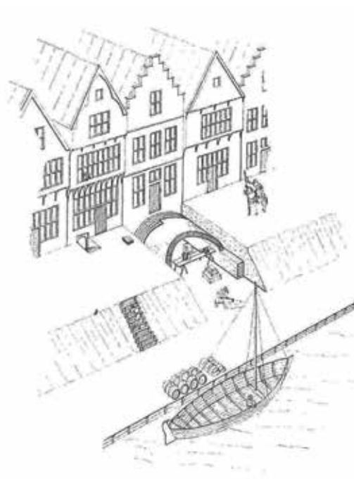
AFBEELDING 2.9 Reconstructietekening van de bouw van een werfkelder in Utrecht
