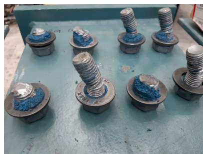
(d) Injection bolts after testing.
