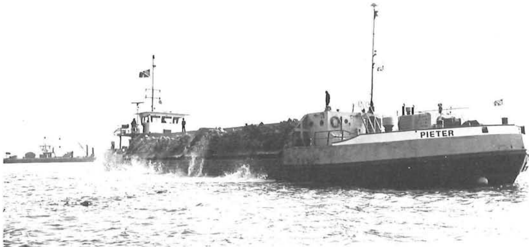
Zelfpostionerende en vrijvarende schuifstorter in bedrijf.
