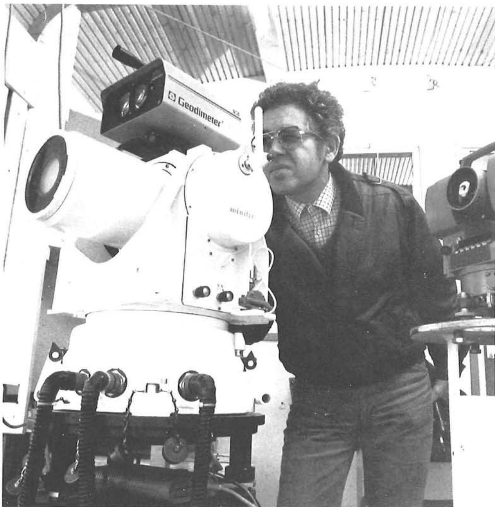
Minilir in combinatie met afstandsmeter "AGA" 112 voor zeer nauwkeurige positiebepaling.
