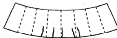
Figuur 44 Buigingsvervorming, schieffstand inpandige bouwmuren
