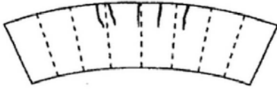
Figuur 48 Buigingsvervorming - Hogging
