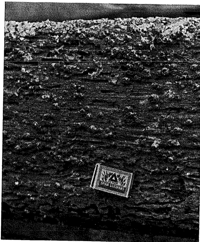
Fig. 222. Paalwormgangen aan de oppervlakte in tropisch hardhout.
