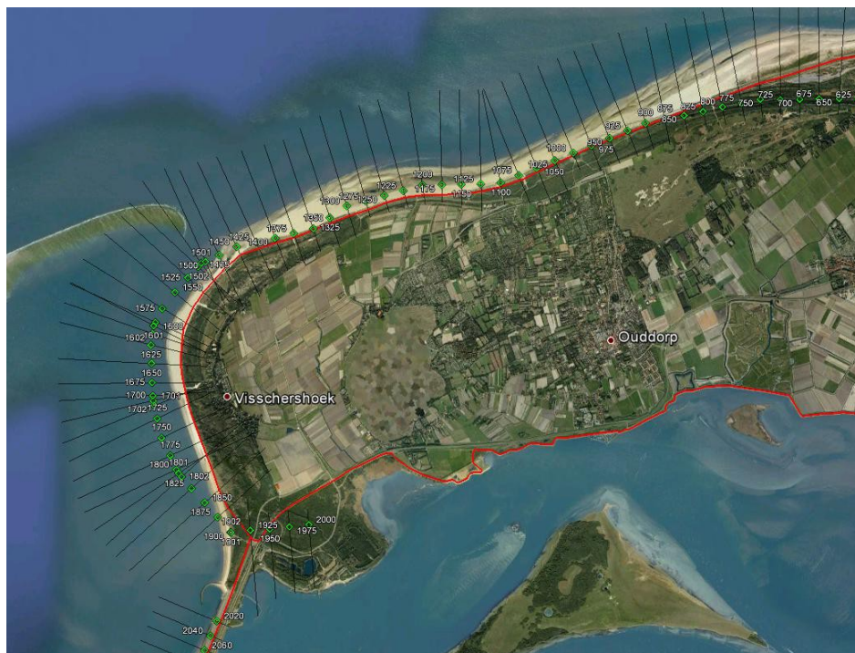
Figuur 2-1 JarKus-raaien langs de kust van Goeree, weergegeven met de zwarte lijnen (bron: Open-EarthTools). De rode lijn geeft de omtrek van de dijkkring aan.
