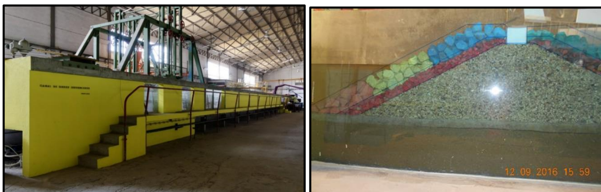
Figura 3. Canal de ondas irregulares COI1 (esquerda) e modelo físico bidimensional (direita)
