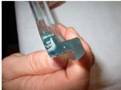
(d) Determine the origin point of the fracture
