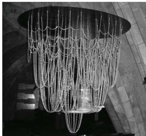
Figure 2.6 Hanging model of the Sagrada Família. [48]
