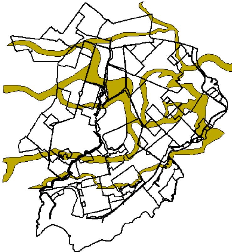
Figuur 20 Zandbanen in de toplaag (bron: TNO, 2001)
