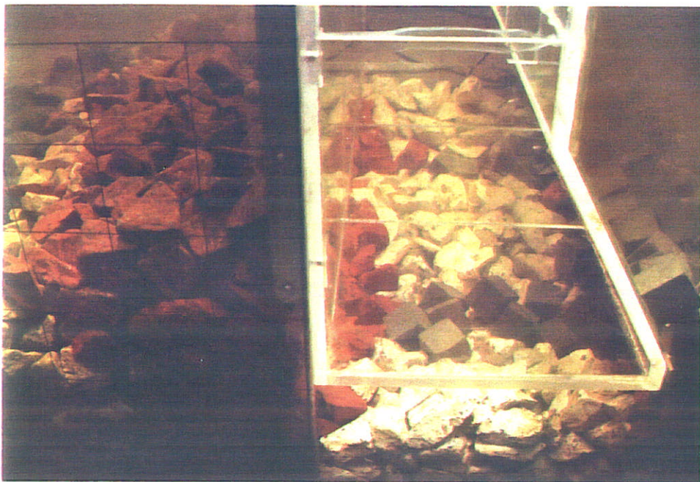
4 Schade aan het eind van proef T 7
