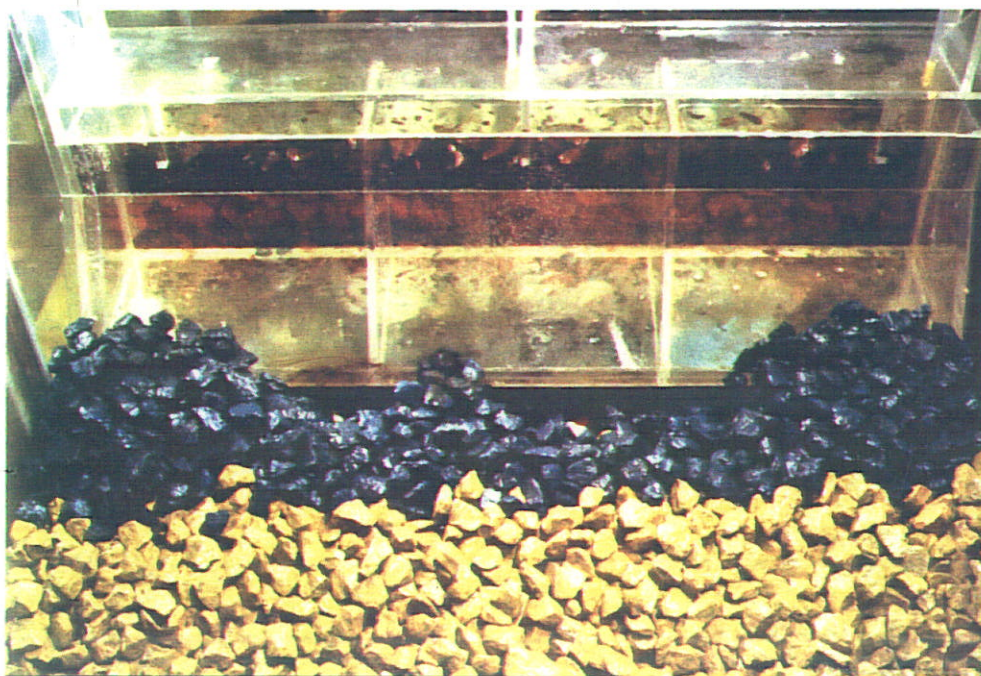
1 Schade aan het eind van proef T_1 (vooraanzicht)
