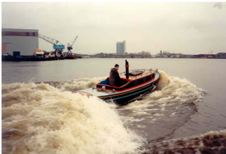
Figuur 1: Golsysteem van een vrijvarend schip met een lengte van \pm 6\text{m} en een snelheid van \pm 11 \frac{\text{km}}{\text{h}} . Bron: http://opduwer.swalker.nl/ & http://www.modelbouwforum.nl/threads/schaalregels-voor-varende-modellen.79102/
