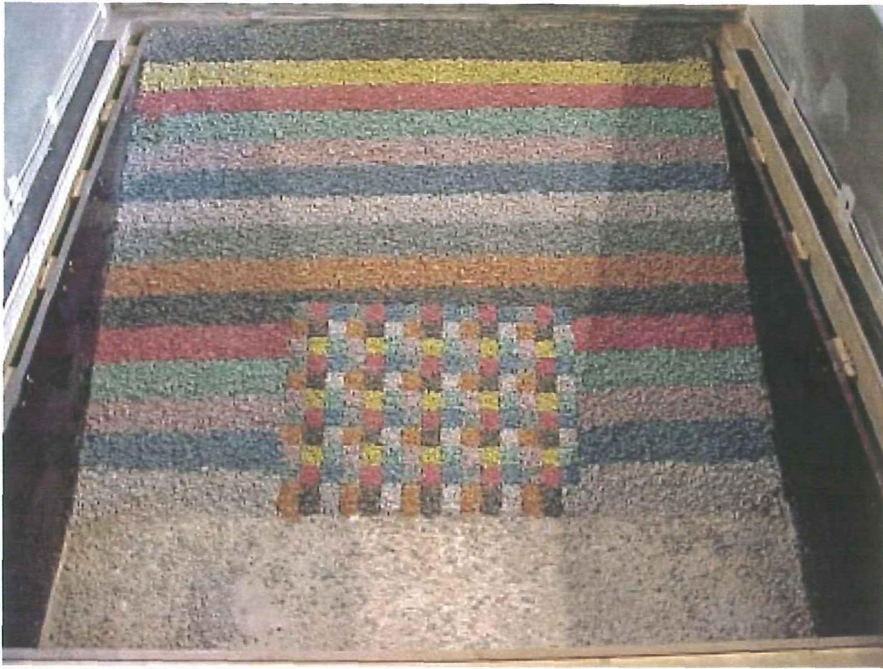
Figuur 3-6: Vierkantjes met gekleurde steentjes op talud.
