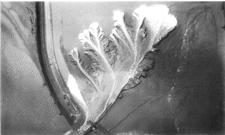
fig. 114. Typische vorm van ontwikkeling van een stroomgeul in de Willempolder op St. Philipsland in februari 1953. Links zijn de slikken langs het Zijpe.
