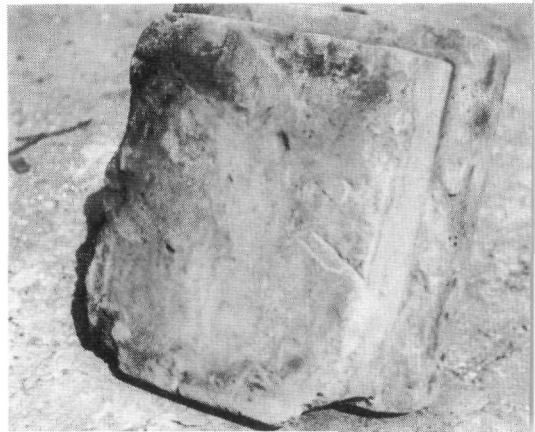
fig. 187. Gebakken glooiingsteen, z.g. „Cormansteen” in het begin van de vorige eeuw gefabriceerd door de steenbakker Corman te Gendt bij Nijmegen.
