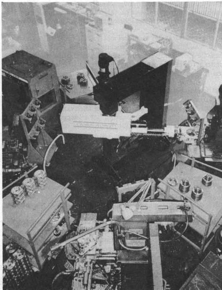
Figuur 2.4 Moderne productie-automatisering: een centraal opgestelde industriële robot laadt en ontlaadt een aantal numeriek bestuurd gereedschapswerktuigen.
