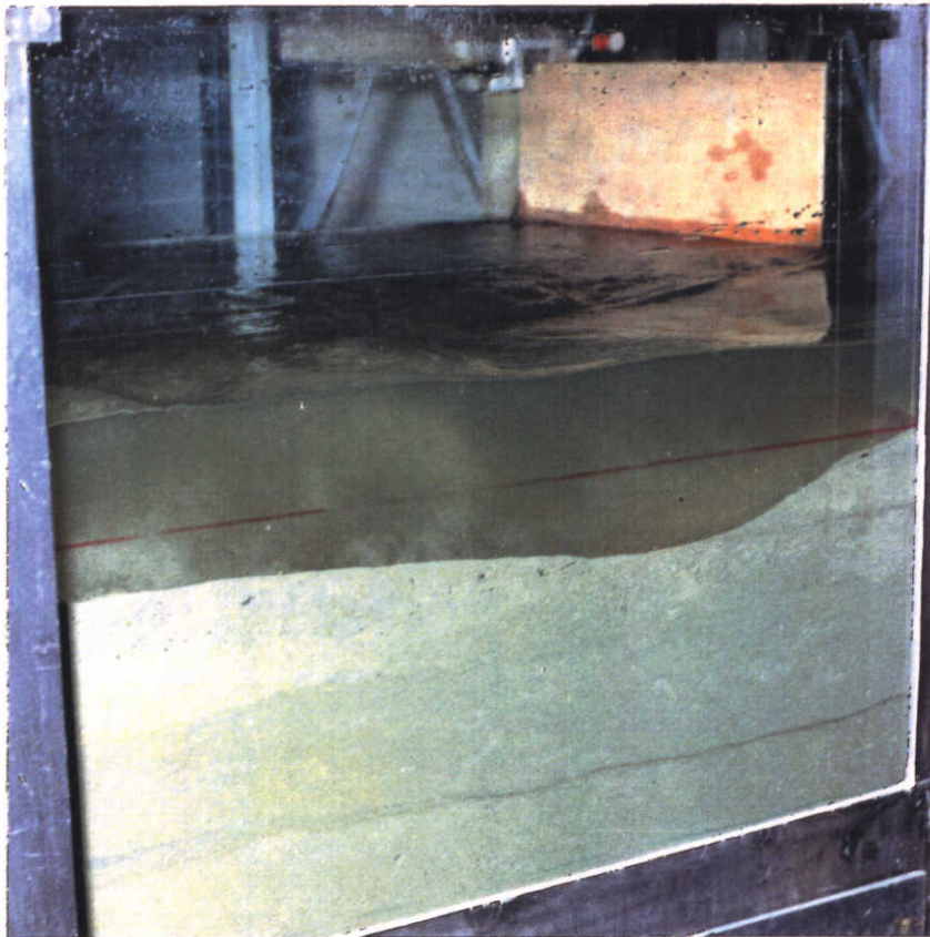
Foto 1 Ontgrondingskuil tijdens proef T4
