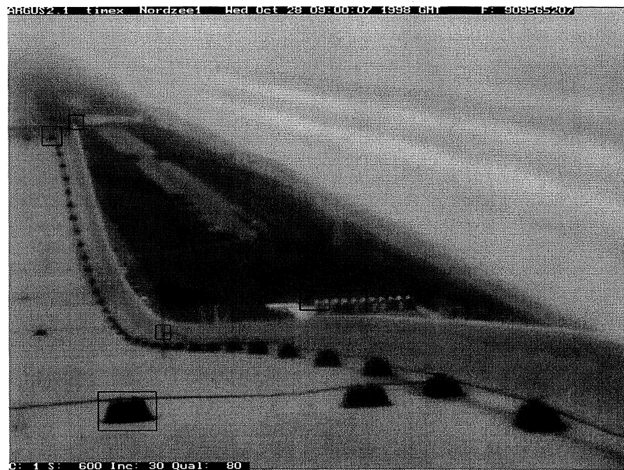
Afbeelding 2c: camerabeeld (doelbeeld) na de verschuiving. Beeldkaders verschoven volgens de met autogeom bepaalde nieuwe geometrie-oplossing.
