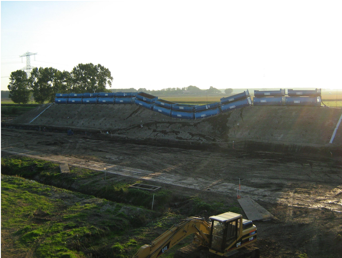
Figuur 3.11 De macrostabiliteitsdijk twee uur na bezwijken.
