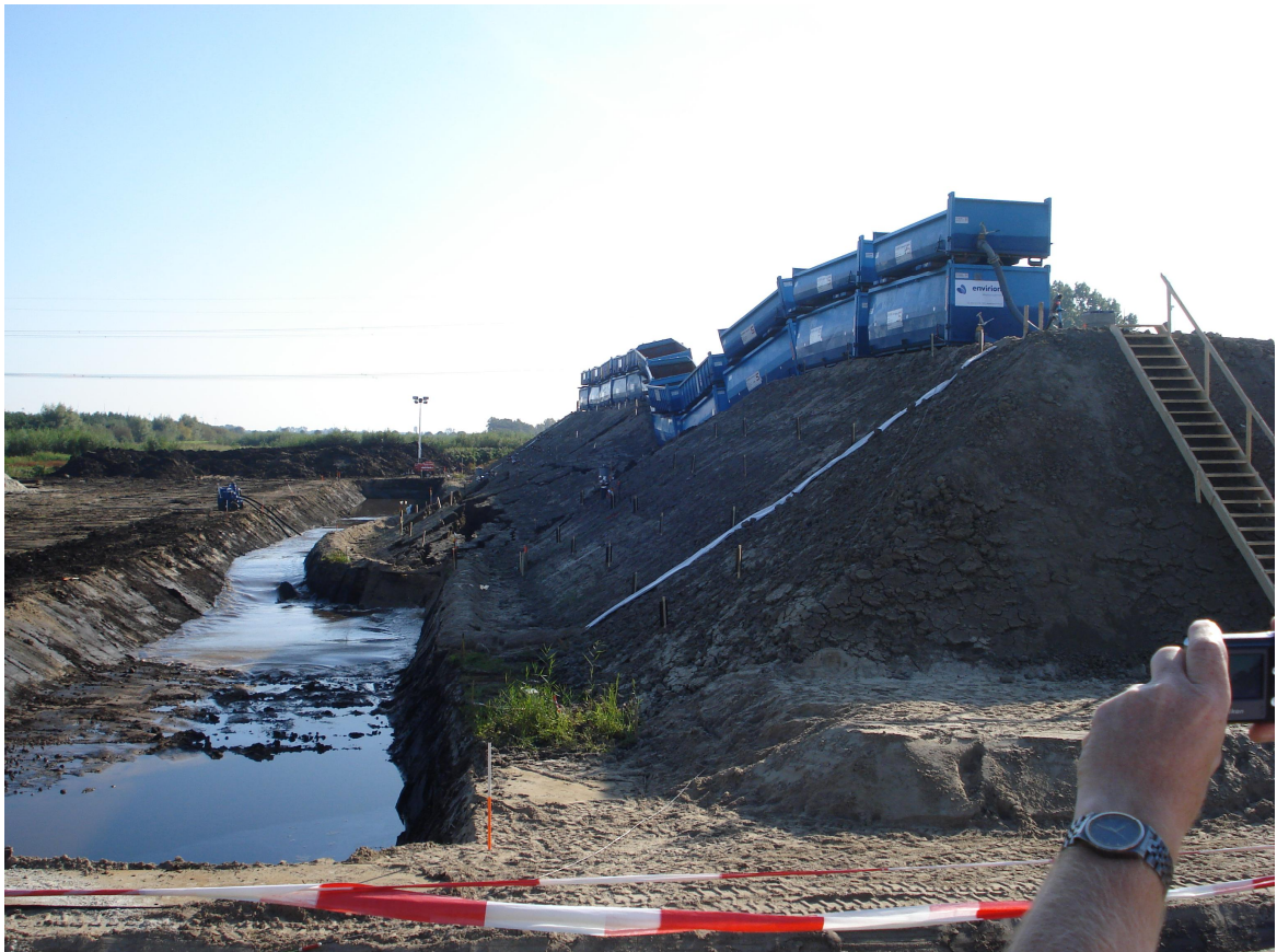
Figuur 3.10 Bezwijken van de macrostabiliteitsdijk op zaterdag 27 september 2008 om 16:02 uur (foto: Rob Meijer, TNO-ICT).
