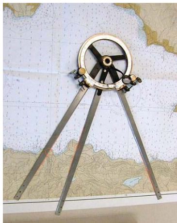
Fig. 4-8 Plaatspasser (station pointer).
