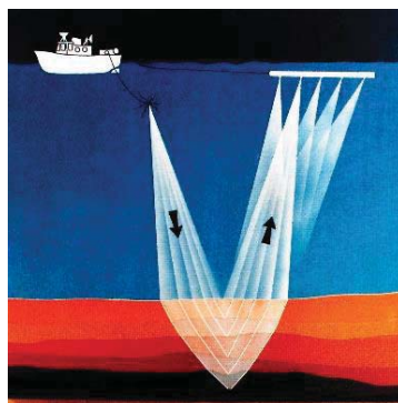
Fig. 5-50 Seismisch onderzoek van de zeebodem door weerkaatsing van geluidsgolven.
