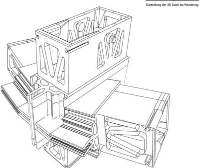
Der Knotenpunkt nimmt Verformungen in allen Richtungen der Fassadenebene auf.
