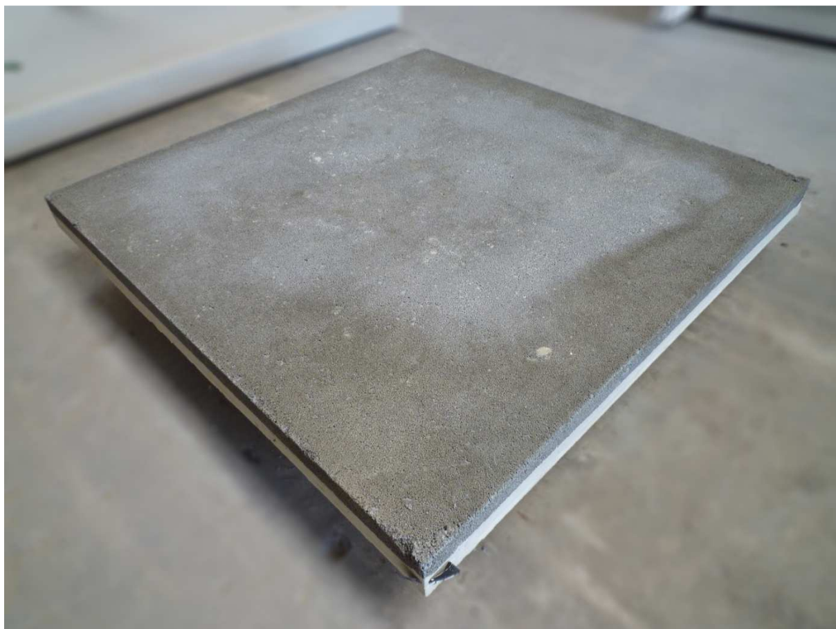
Afb. 3.1.5a: Proefstuk B.01 – poreus beton.
