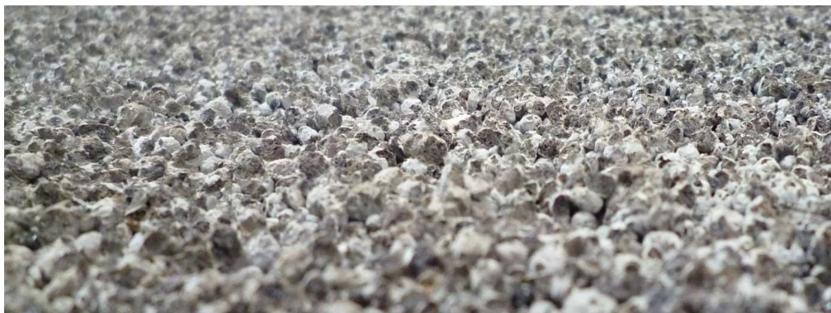
Afb. 3.1.5d: Detailfoto van proefstuk B.03 – poreus beton, gestraald.
