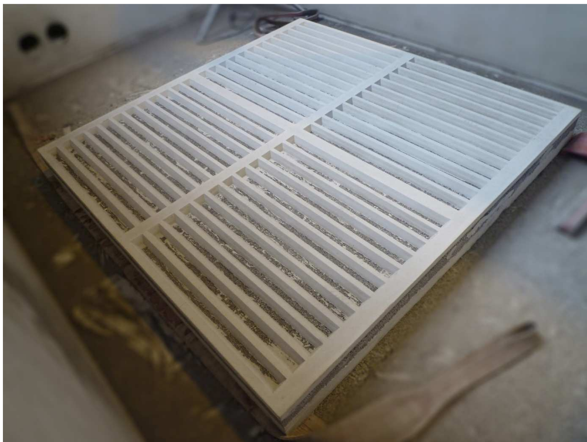
Afb. 3.1.5f: Proefstuk C.01 – geperforeerd beton.
