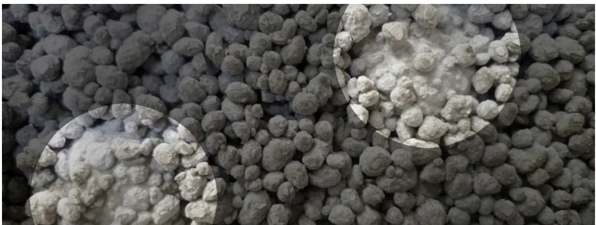
Afb. 3.2.4e: Klonten die zijn ontstaan, hier zichtbaar aan het oppervlak van het proefstuk.
