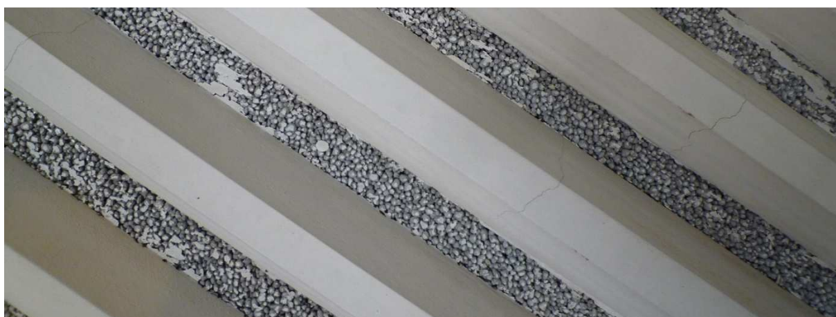
Afb. 3.1.5g: Detailfoto van proefstuk C.01 – geperforeerd beton.
