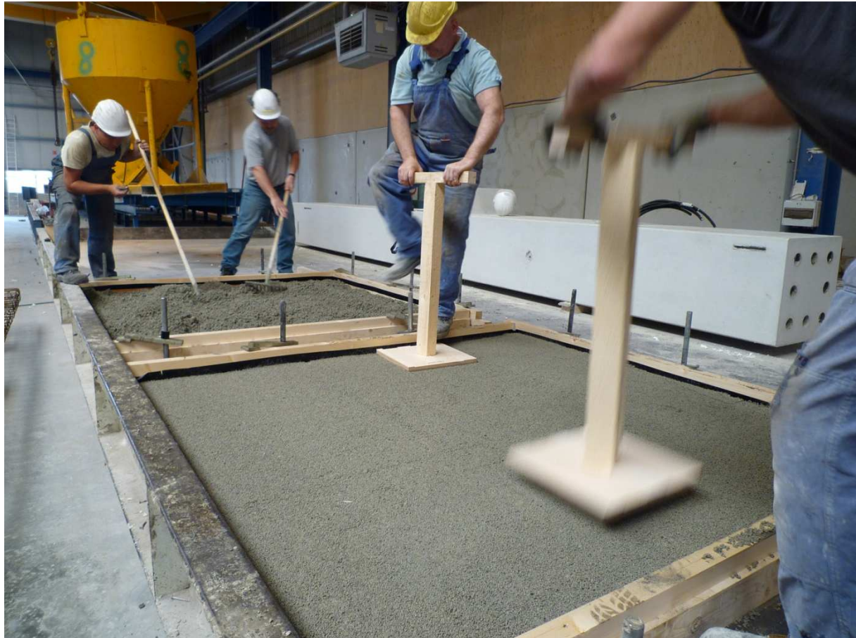
Afb. 4.0a: Het aanstampen van het poreuze betonmengsel in de mal van proefstukken B.01 en B.03.
