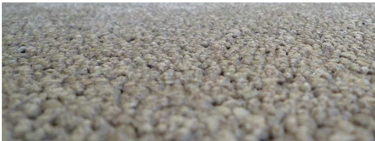
Afb. 3.1.5b: Detailfoto van proefstuk B.01 – poreus beton.
