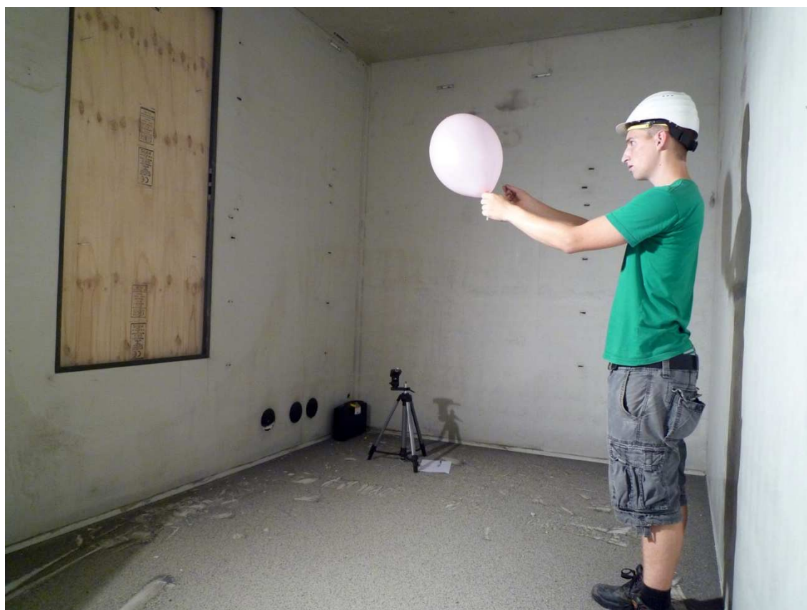
Afb. 3.2.1b: De meetopstelling in de nagalmkamer voor de referentiemeting, A.00.
