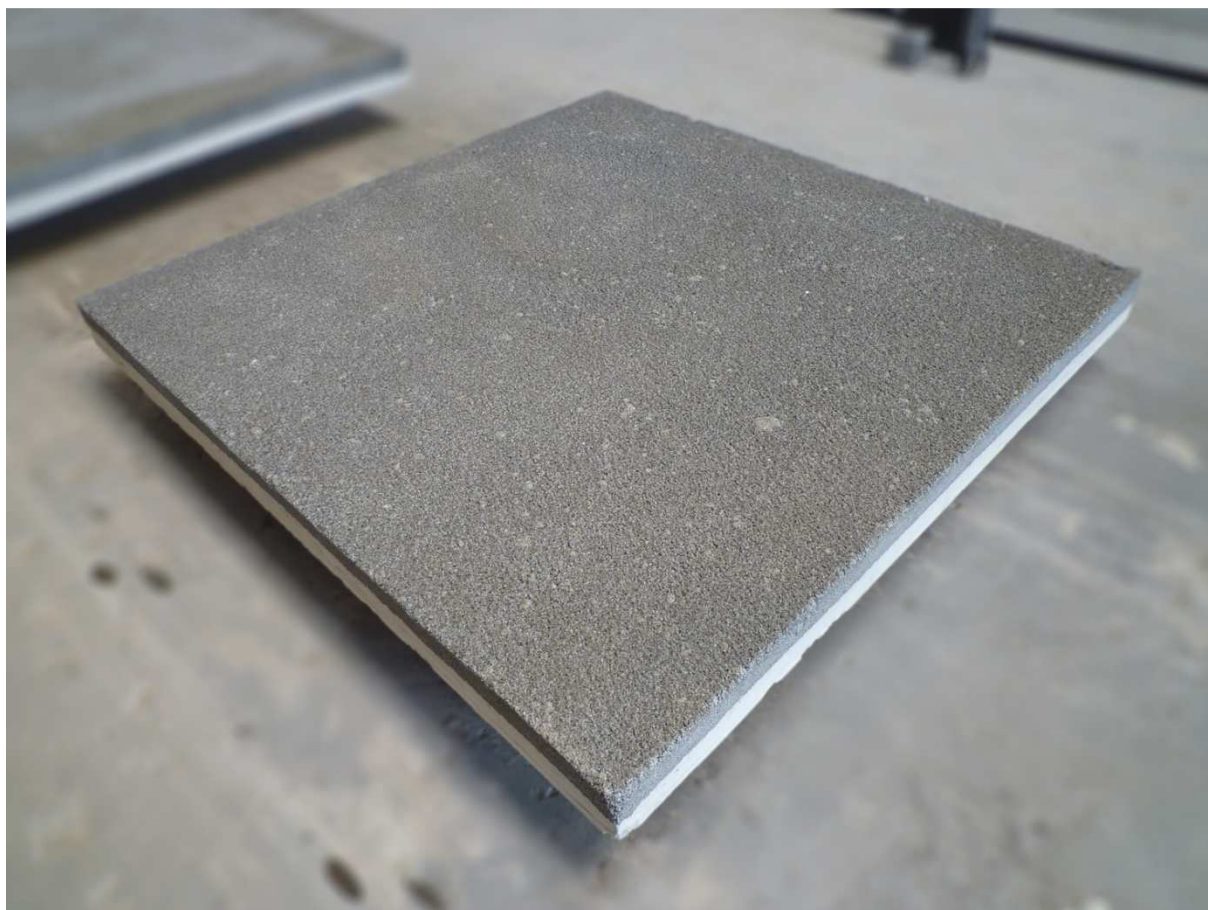
Afb. 3.1.5c: Proefstuk B.03 – poreus beton, gestraald.
