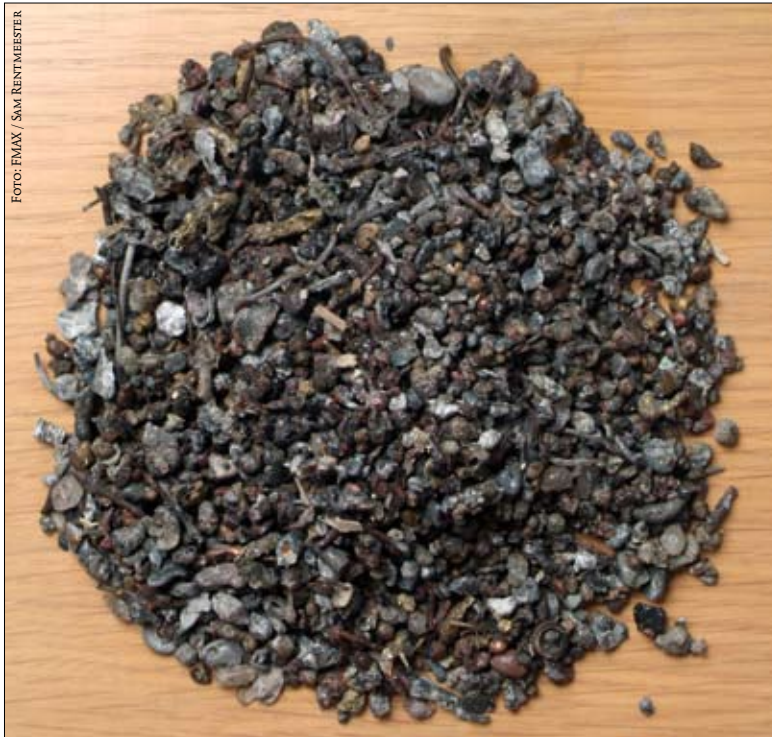
Fijne metaaldeeltjes uit huishoudelijk afval: smelt van zware non-ferro fractie uit bodemas
