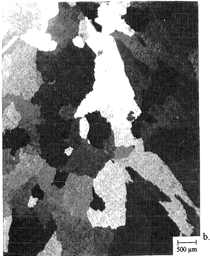
Figuur 4.4. Middelfijnkorrelig materiaal (wachtijd: ½ minuut). a. De gietstructuur. b. De gehomogeniseerde structuur.
