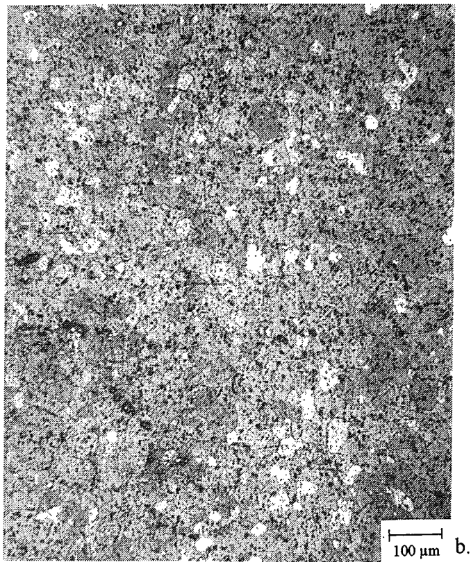
Figuur 4.19. Korrelstructuur van het aluminium na het extruderen. a. Fijne korrelstructuur voor het deformereren. b. Middelfijne korrelstructuur voor het deformereren.
