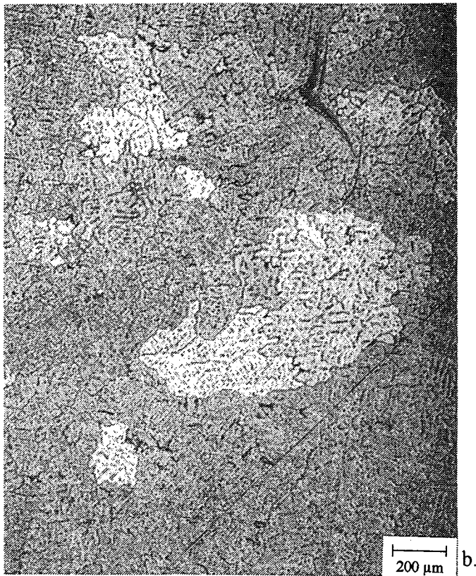
Figuur 4.1. Korrelstructuur van het aluminium verfijnd met tior. a. gehalte Ti = 0,01 gew% b. gehalte Ti = 0,005 gew%
