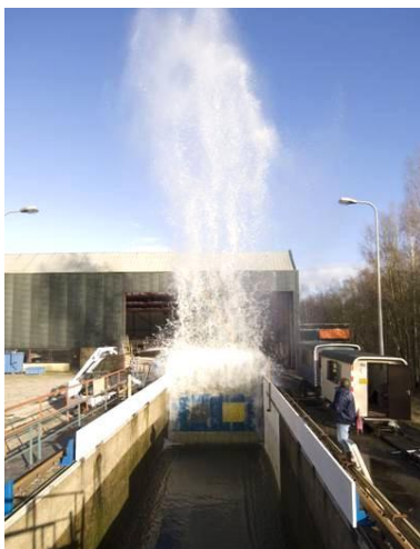
Foto 3.4 Impressie van de Deltagoot van Deltares (project waarbij de krachten van een golfimpact op een verticale wand wordt gemeten).
