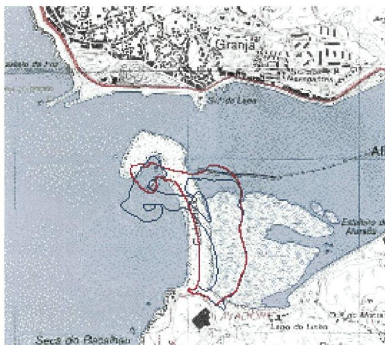
**Figura IX.8** - Sobreposição do primeiro e do último levantamento efectuados no Cabedelo através de GPS com a Carta Militar de Portugal, Folha 122, de 1981, à escala 1:25000. (escala da figura 1:22250).
