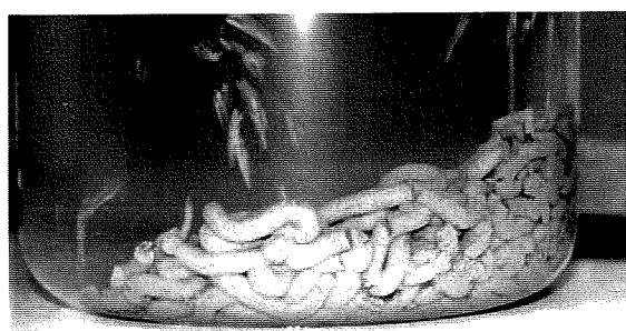
Foto 8.7: De slangetjes additief blijven op een hoopje op de bodem liggen
