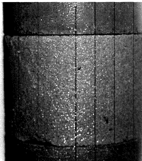
Foto 11.2: Monster met additiefsamenstelling E4 na de erosieproef
