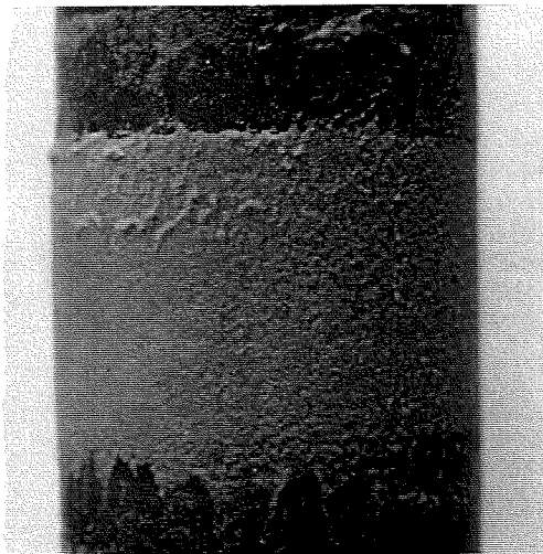
Foto 10.22: Monster met additiefsamenstelling F3 voor de erosieproef
