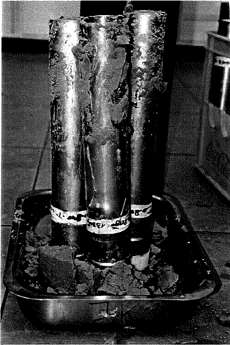
Foto 10.1: Uit één cilinder (één groot monster) kunnen met behulp van steekblikken vier (kleinere) monsters gestoken worden
