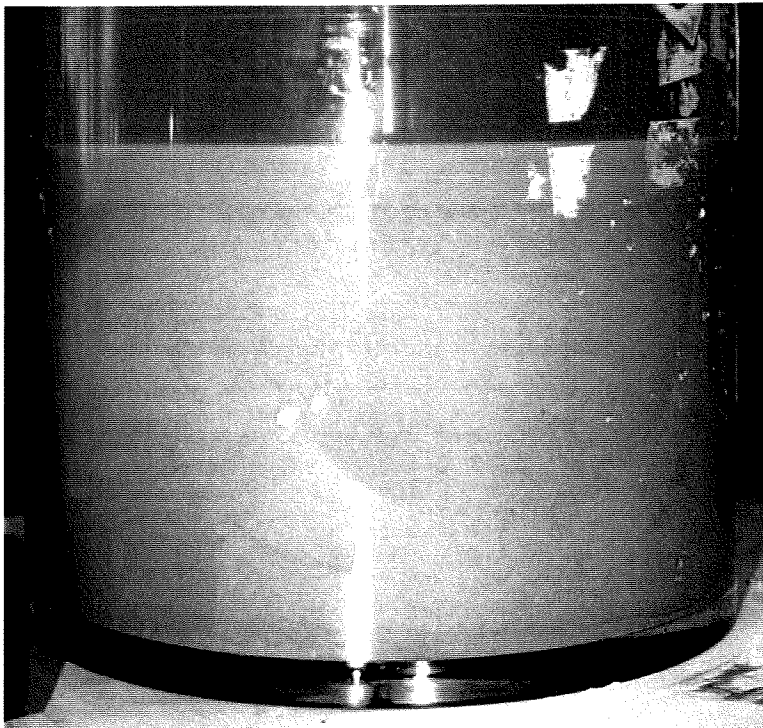
Foto 9.2: Nadat het geheel is opgeroerd ligt er een laag additief van enkele centimeters op het zand
