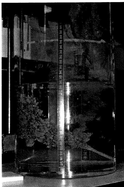
Foto 8.5: De wolk additief verspreidt zich in de onderste 10 cm van de cilinder
