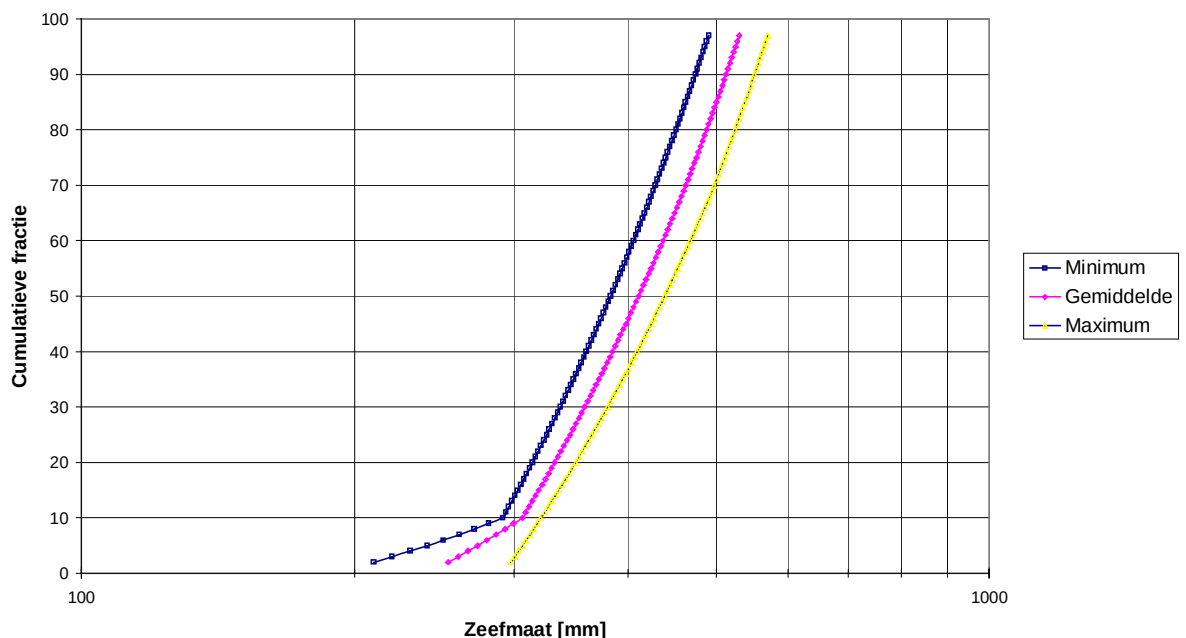
Figuur 4.3: vorm voor proefgradering is gelijk aan standaardgradering 40-200 kg
