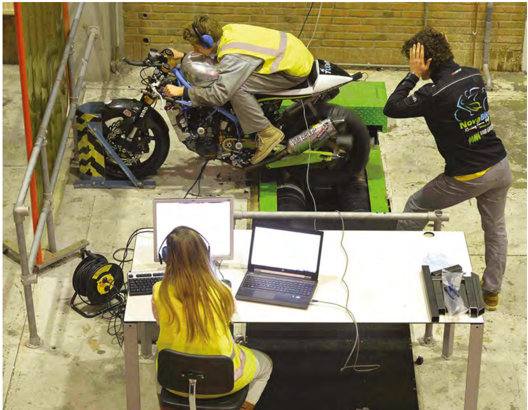
Figuur 2 | Vermogensmeting van een van de motoren van NovaBike op de rollenbank in de D:DREAM Hall in de tijd dat er nog verbrandingsmotoren gebruikt werden. Toen kon er alleen 's nachts getest worden vanwege het oorverdovende lawaai. Met de elektrische motoren van nu ligt dat even anders, . . .
