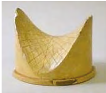
Figuur 4 | Gipsmodel DLib 24 uit de academische erfgoedcollectie van de TUD: hyperbolische paraboloid.
