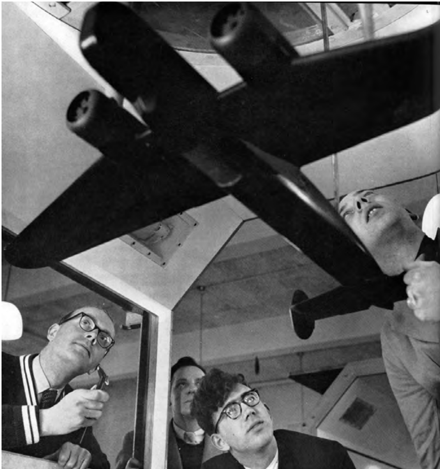
Figuur 3 | Schaalmodel van de Fokker T-5 in een inzetstuk van de Lage Snelheids Windtunnel [9].
