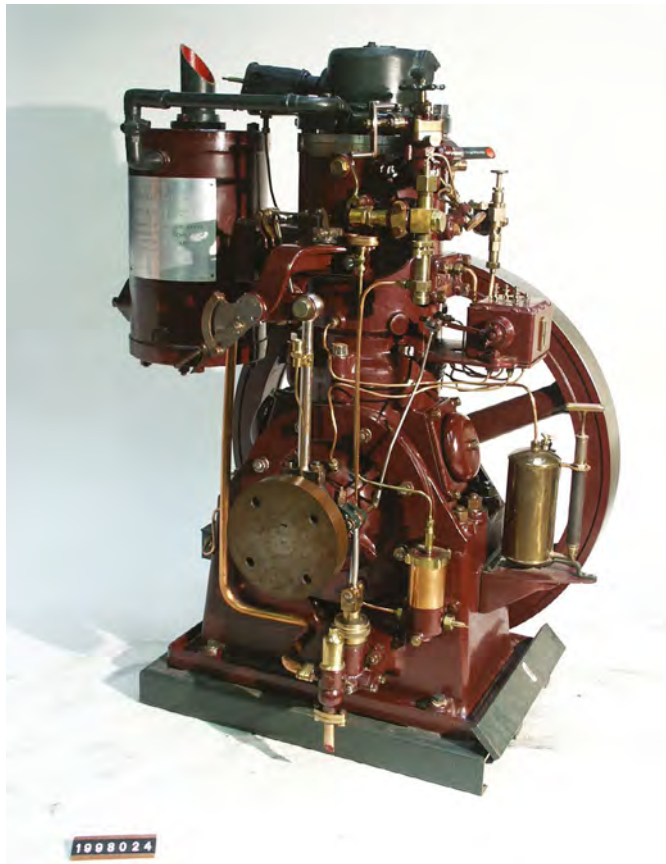
Figuur 3 | Kromhout tweetakt ruwoliemotor No. 545, type RO1S, 18 pk, afgeleverd oktober 1911 aan de Poelpolder te Zuid Schalkwijk. Onderdeel van de TU Delft erfgoed collectie. In bruikleen gegeven aan het Kromhout museum in Amsterdam.
