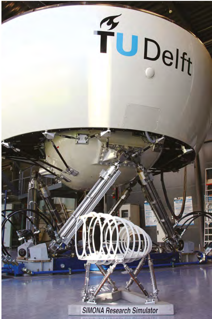
Figuur 3 | Op de voorgrond: model van het skelet van de eivormige kern van de SIMONA vluchtsimulator. Op de achtergrond: de operationele, lichtgewicht SIMONA Research Simulator.
