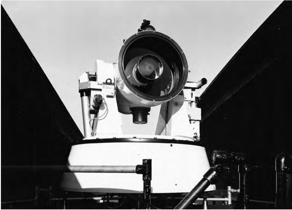
Figuur 1 | De laserafstandsmeter in de koepel van het OSG te Kootwijk. (Foto TU Delft.)
