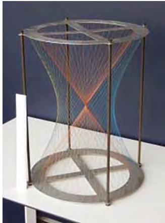
Figuur 2 | Draadmodel D 41 uit de studieverzameling van EWI: hyperboloïde (lichtblauw) en dubbele kegel (rose) als limietgeval.
