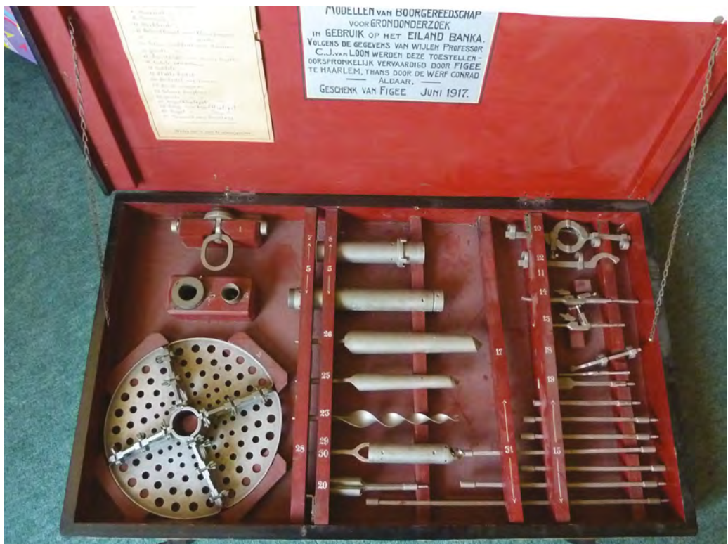
Figuur 4 | Miniatuur model van Banka-boor, geschonken in 1917 door de Firma Figee.
