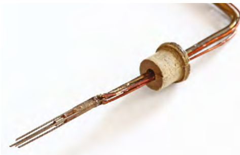
Figuur 2 | Kruisdraadprobe uit de jaren '60.
