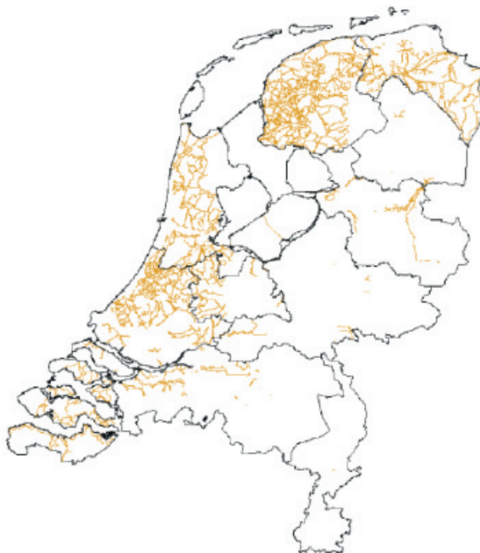
Figuur 39. De 15.000 km secundaire waterkeringen (in geel). De veiligheidsnormen voor deze keringen worden vastgesteld door de provincies.
