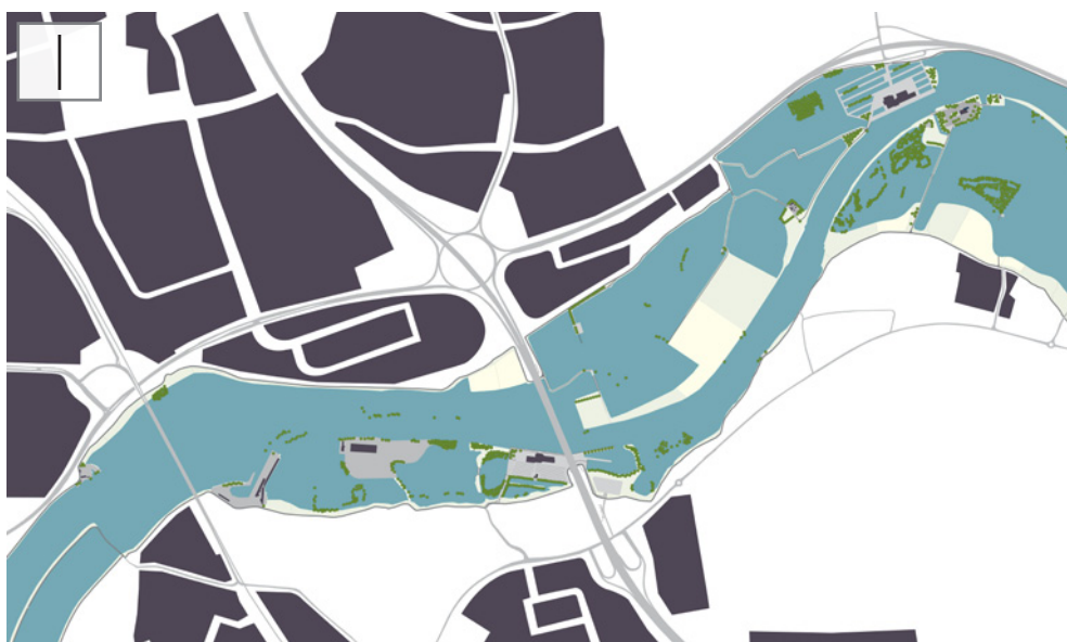
Figuur 40: Waterstijging naar 11.00 m boven NAP Bron: eigen tekening
