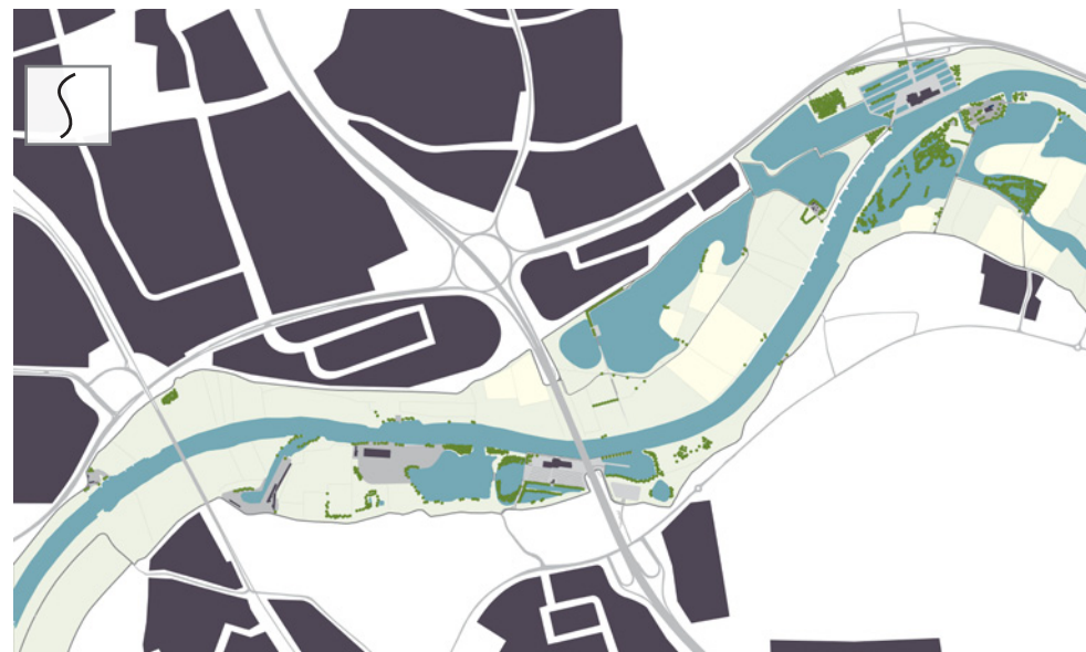
Figuur 39: Waterstijging naar 9.50 m boven NAP Bron: eigen tekening
