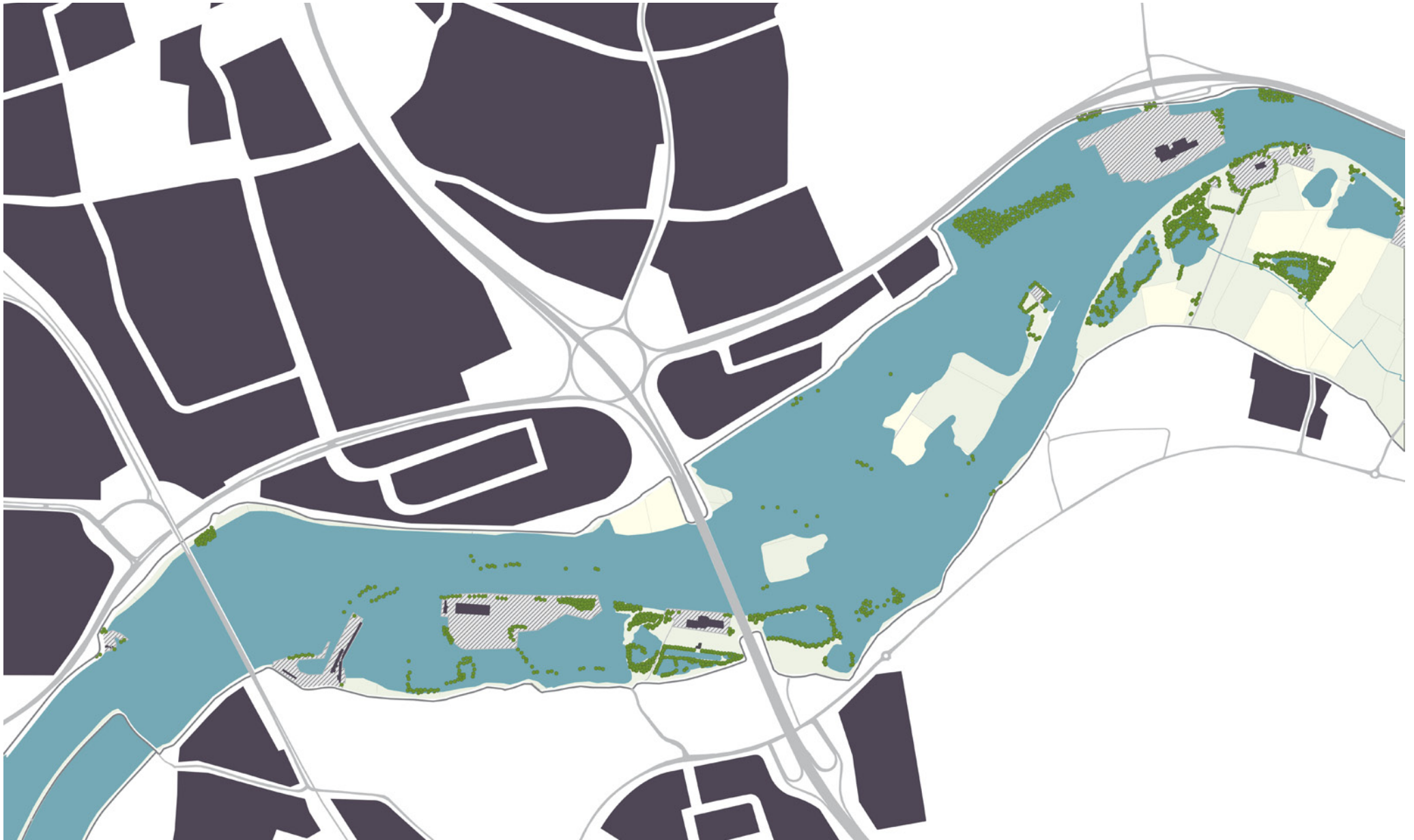
Figuur 33: Waterstijging tot 11.50 NAP [3.00 m boven gemiddeld zomerpeil]. Bron: eigen tekening
