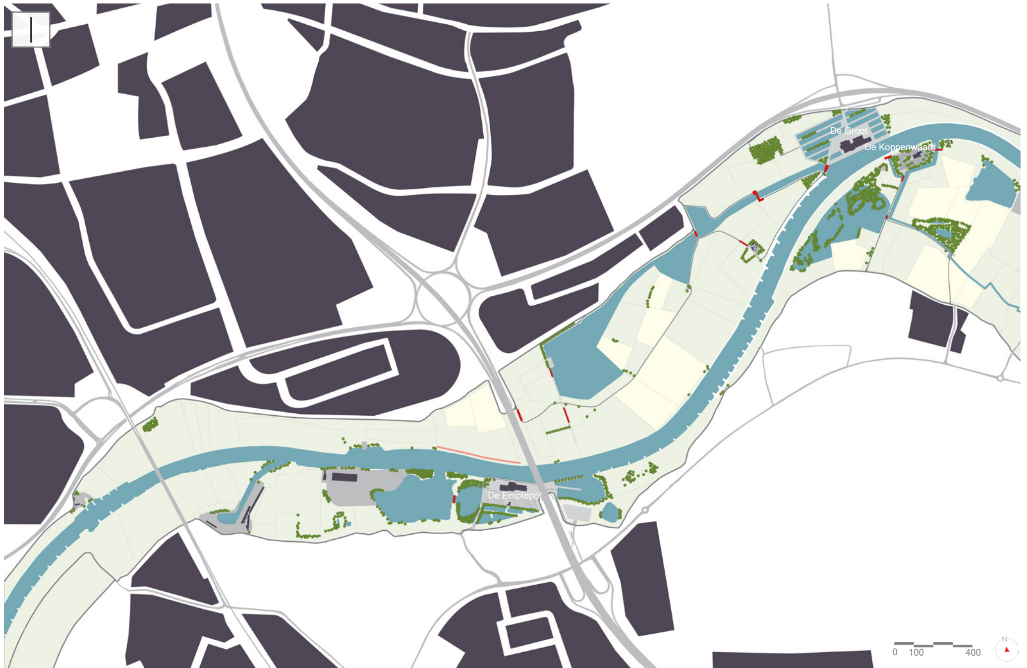
Figuur 38: Plankaart met waterinlaten binnen landschapsplan bij gemiddelde zomerwaterstand van 8.50 m boven NAP. Bron: eigen tekening
