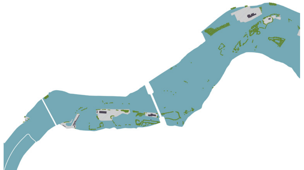
Figuur 32: Waterstijging tot 12.00 NAP [3.50 m boven gemiddeld zomerpeil]. Bron: eigen tekening
