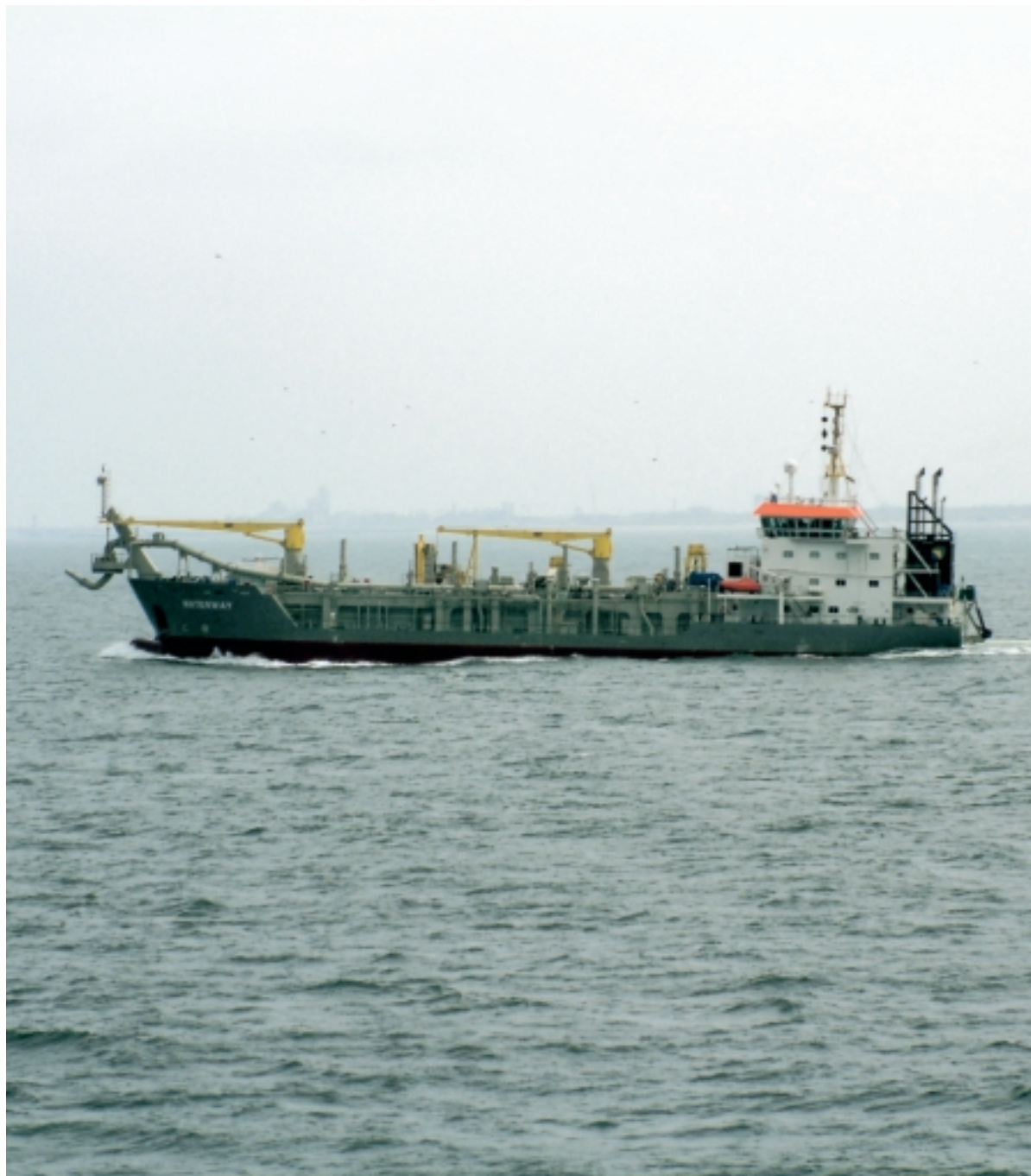
Voor onderwatersuppleties zijn schepen met een beperkte diepgang nodig. Hier de sleeophopperzuiger "Waterway". (Foto Directie Noordzee RWS)
