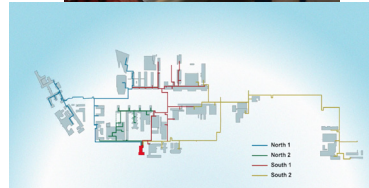
Aangesloten op het warmte/koude net van de TU Delft dat wordt omgezet in een Smart Thermal Grid
