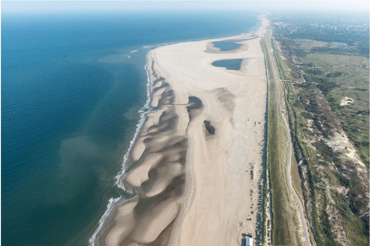
Foto 15: Het lage water op deze foto toont het indrukwekkende stelsel van geulen, ruggen en zandplaten aan de zuidkant van de Zandmotor. 1 oktober 2013. Foto Joop van Houdt.
