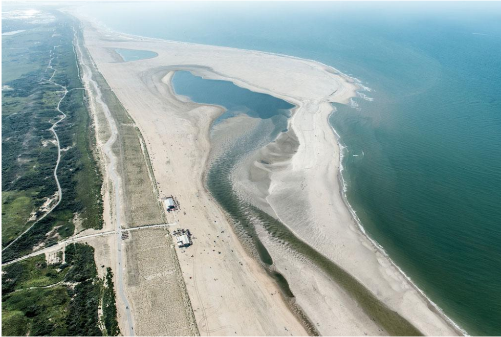
Foto 5: De Zandmotor op 4 september 2012. Waar de krekken in de baai van de Zandmotor uitmonden is een uitgebreid stelsel van zandplaten en wadvlaktes ontstaan. Foto Joop van Houdt.
