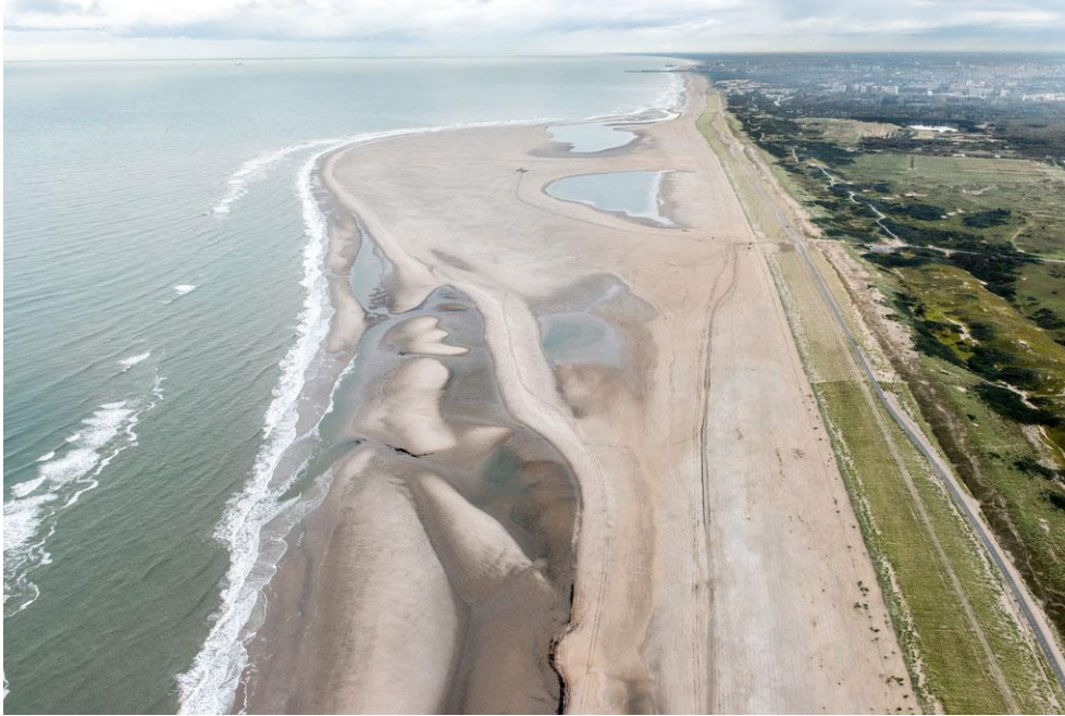
Foto 13: De zuidzijde van de Zandmotor op 31 oktober 2012. Een strandmeer, zwinnen, muien en strandruggen laten een indrukwekkende dynamische aangroeikust zien. Foto Joop van Houdt.
