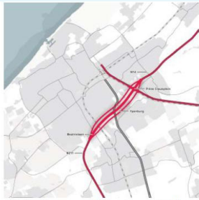
Optimaliseren parallelstructuur: middellange parallelstructuur in combinatie met dubbele knoop op het Prins Clausplein
