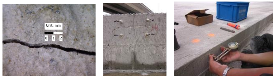
Figuur 8. Scheurbreedtemeting aan het verhardingsoppervlak met een digitale microscoop (links) en meting van de scheurbreedteverandering aan de rand van de verharding met een LVDT (midden en rechts)
