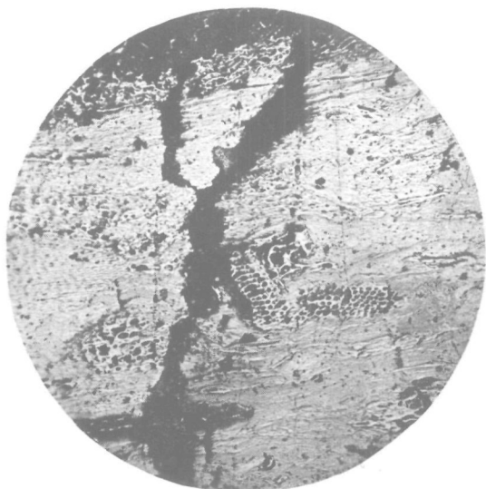
Foto 1. Fusiërijke kool; 40 × vergroot; niet geëst. Boven: rand van een fusietband. Links: vitriet-fusiet overgang.
