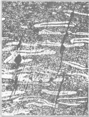
Foto 6. Magerkool; 45 \times vergroot; geëtst. Geteekende kool met macro- en microsporen.
