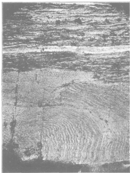
Foto 4. Gasvlamkool; 40 × vergroot; geëst. Boven: geteekende kool; veel voorkomend beeld met onherkenbare tekening. Onder: Vitriet met celstructuur.
