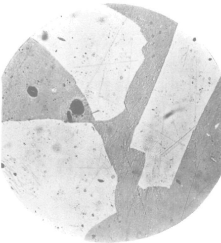
Foto 10. Glanskool van laag D; 75 × vergroot.
