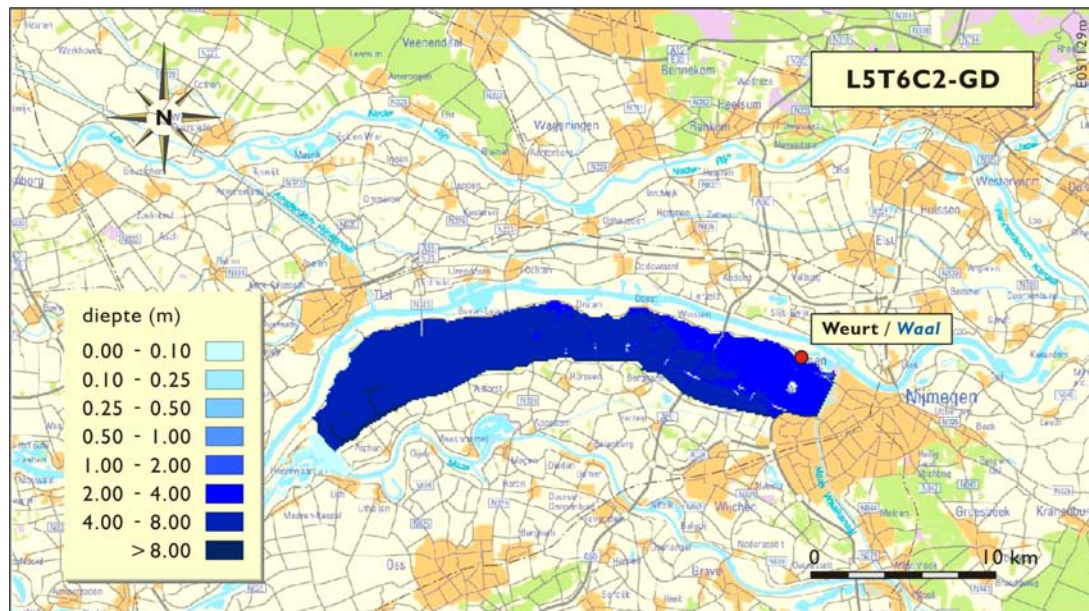
Figuur 5-11 Verschillen in maximaal opgetreden waterstanden tussen scenario L5T6C2 (dijkdoorbraak bij Weurt 6 uur voordat bij Weurt de hoogste rivier waterstand wordt bereikt; dijkkring 41 gecompartmenteerd) en de referentieberekening GD zonder dijkdoorbraken
