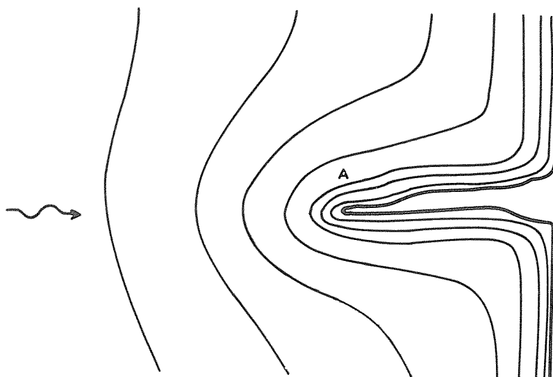
Figuur 2.2 Potentiaalbeeld rondom een kanaaltje in een horizontale doorsnede
