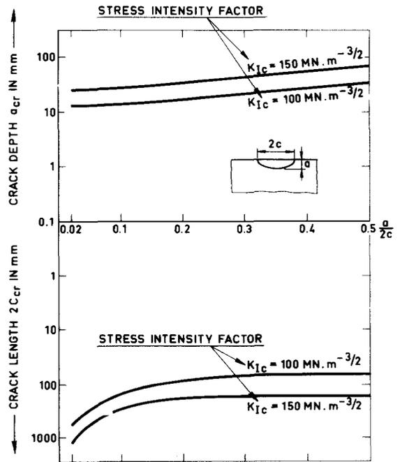
Fig. 3. Fracture: critical surface flaw size (for  $\sigma_0 = \sigma_y = 400 \text{ MN/m}^2$ ; ref.: IRS-Fachgesprach: "Die Sicherheit v. Rohrleitungen u. Druckbehältern in Kernkraftwerken", Bonn Nov. 1970 (Paper H. Spähn/H.W. Lenz).
