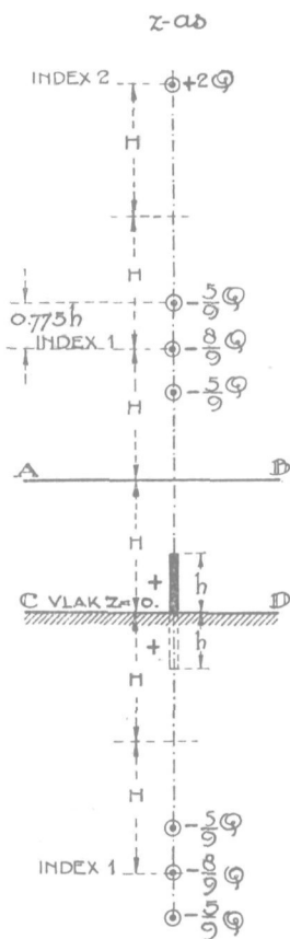
Fig. 25. Schema voor spiegeling van het putfilter.
