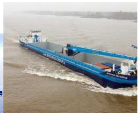
afbeelding 6. AMS barge met eigen kraan (bron: http://www.mercurius-group.nl/ ).
