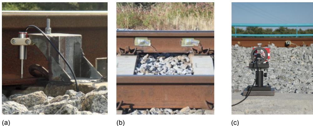
Figure A.2: a) LVDT (Paixão, A., et al., 2015) b) Strain gauge (Paixão, A., et al., 2018) c) PSD (Paixão, A., et al., 2014)
