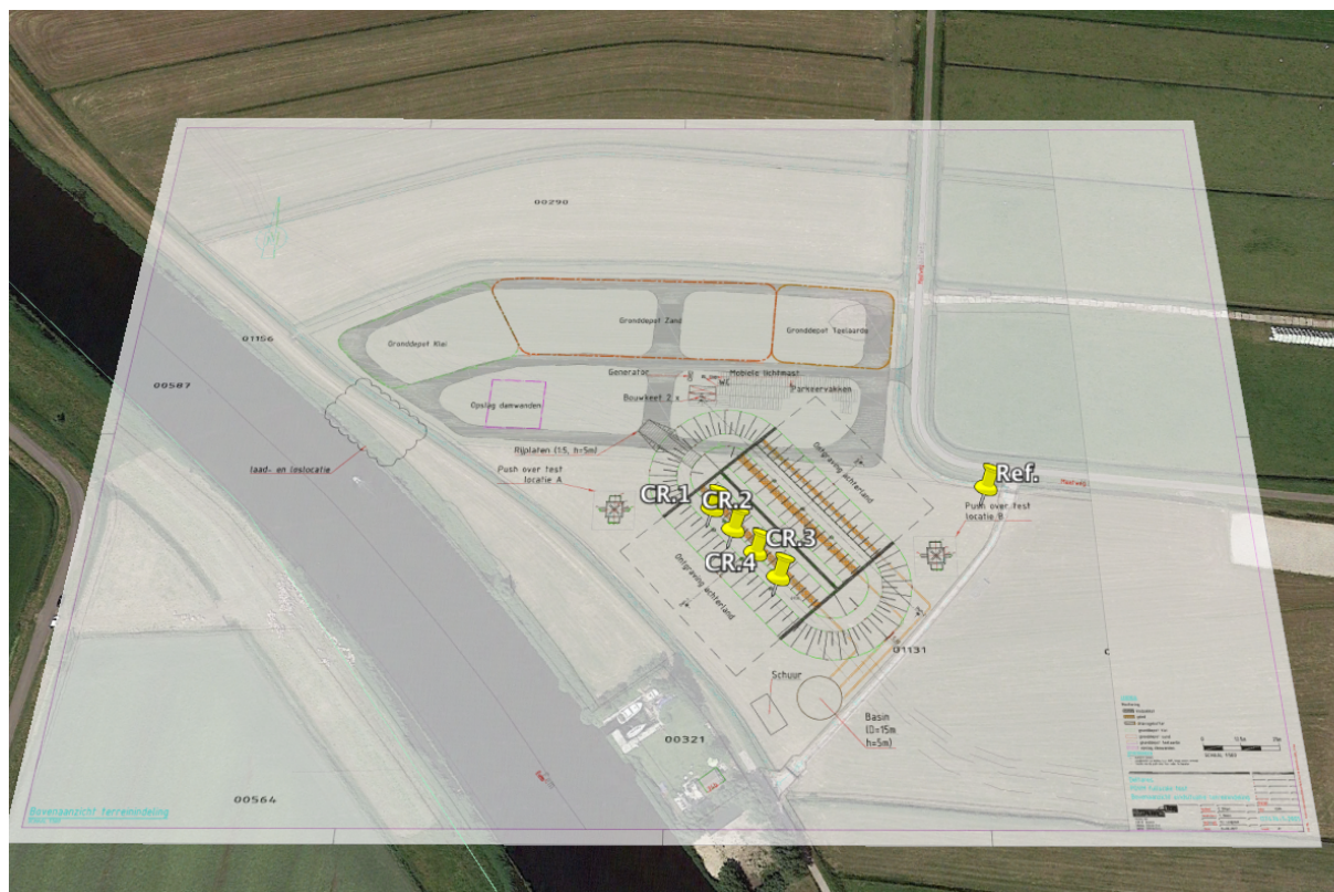
Figuur 5 Locaties van de 4 hoekreflectoren op de groene dijk en de referentiehoekreflector in het testgebied van Eemdijk.
