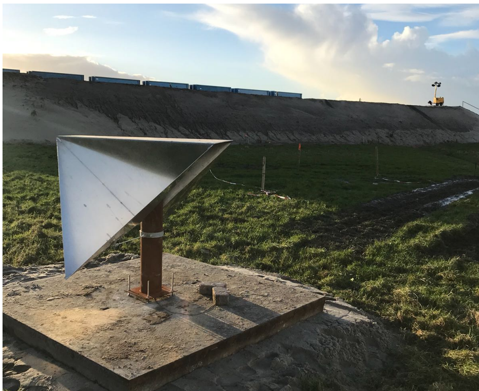
Figuur 7 De referentiereflector (Hanssen, 2017). De reflector is geïnstalleerd op een stelcon plaat, bovenop een extra aangebrachte zandlaag.
