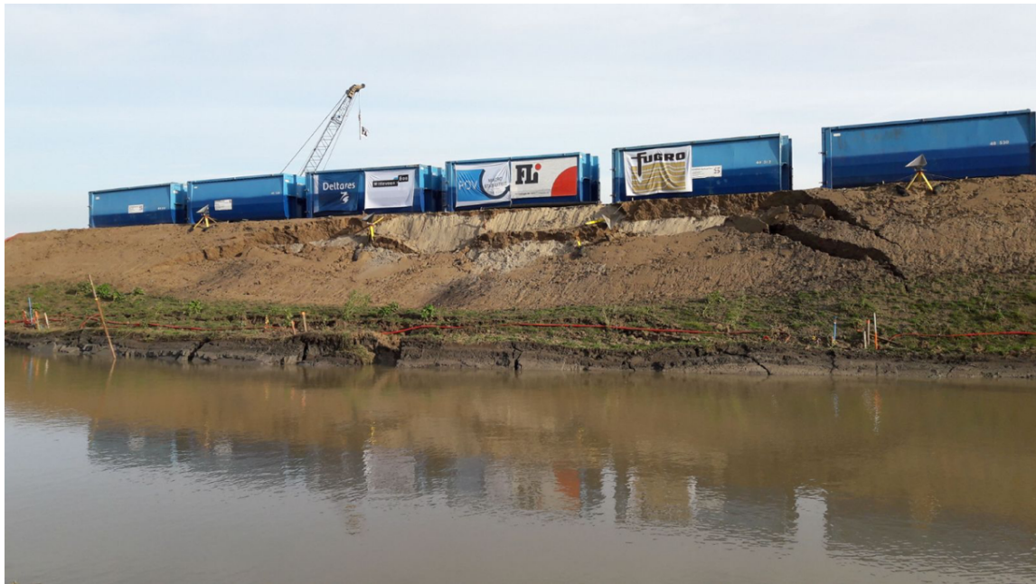
Figuur 8 Foto van het bezwijken van de groene dijk.
