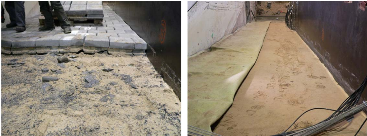
Abbildung 8.24: Umlagerungen im Kornfilter des Abschnitts 1 infolge des Versuchsprogramms links: Erscheinungsbild des Sandkerns infolge des Versuchsprogramms
