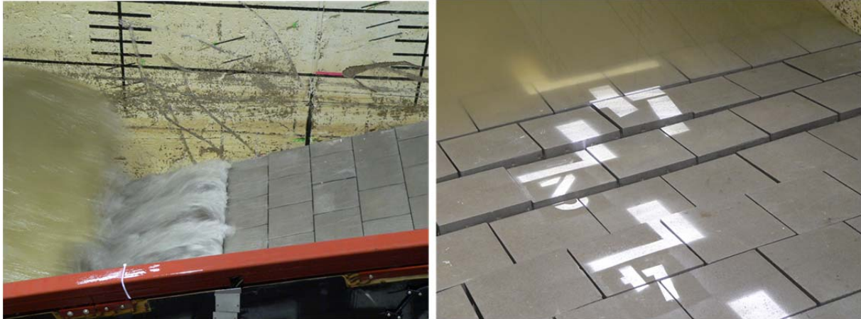
Abbildung 8.3: Darstellung des Abschnitts - 2 links: Herausschießendes Wasser aus den aufgeweiteten Längsfugen während des Wellenablaufs; rechts: Detailaufnahme im Bereich des Ruhewasserspiegels mit lokalen Setzungen und Hebungen
