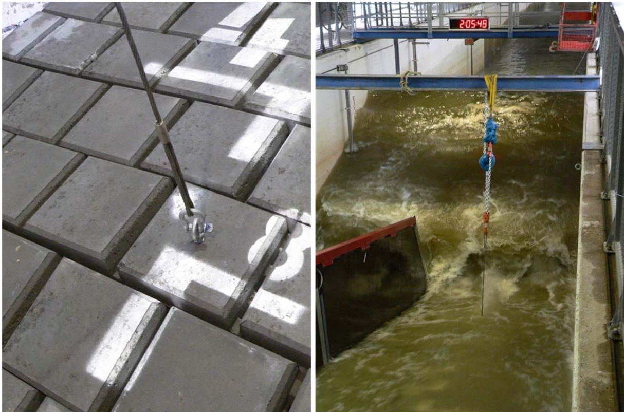
Abbildung 5.16: künstliche Fehlstelle in Modellphase 4, Abschnitt 2 während des zusätzlichen Versuchsprogramms
