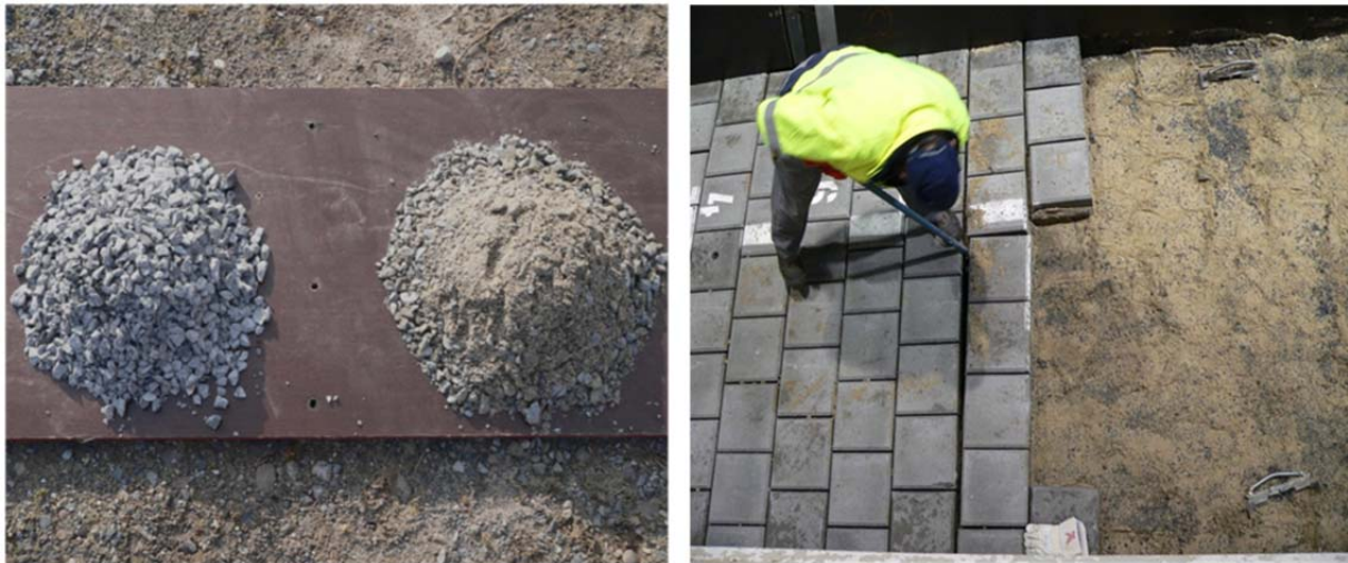
Abbildung 5.10: links: Kalksplitt 2 bis 16 mm vor und nach der Modellphase 2; rechts: mit Sand versetzter Kornfilter während des Ausbaus
