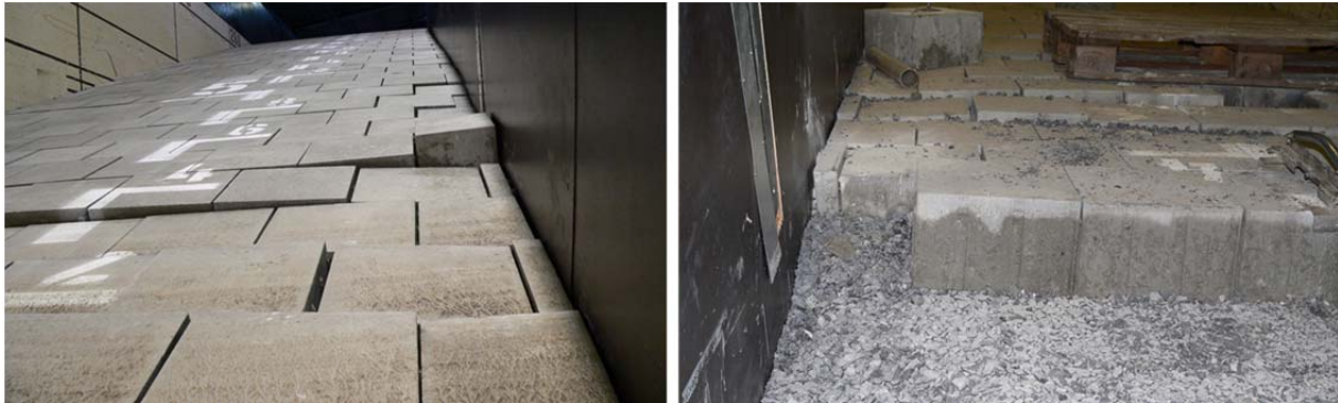
Abbildung 8.5: Versagen des Pflastersteins 180°mm nach DIN EN 1338 (2003) im Abschnitt 2 der Modellphase 1
