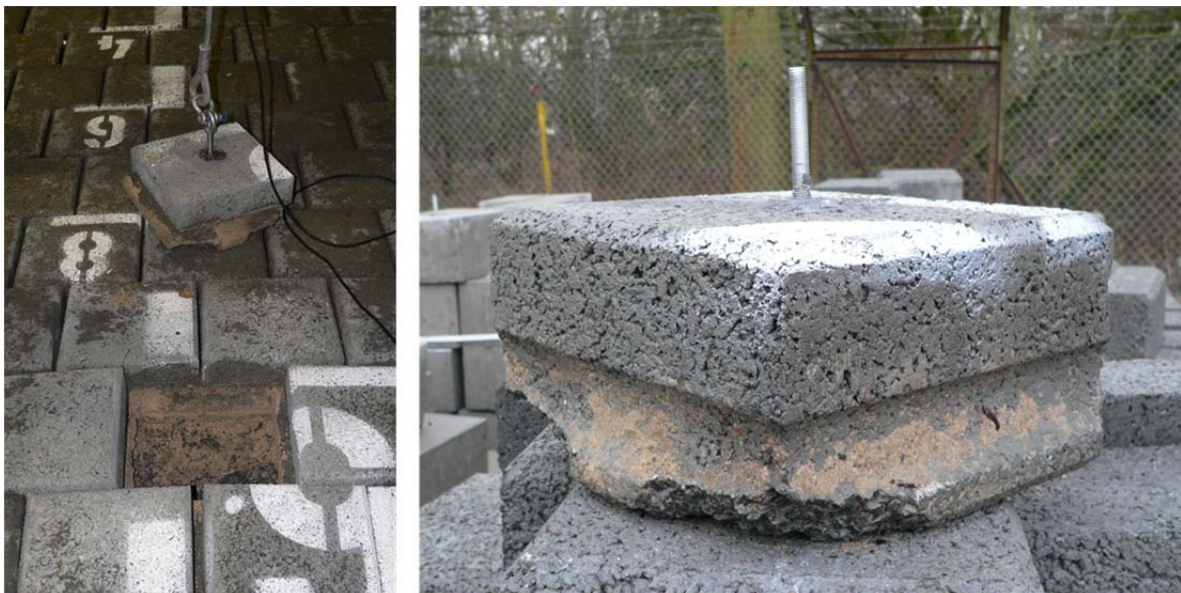
Abbildung 8.21: links: ausgezogener, haufwerksporiger Verkalit®-Deckwerkstein 47-N, Abschnitt 2; haufwerksporiger Verkalit®-Deckwerkstein 47-N im Detail
