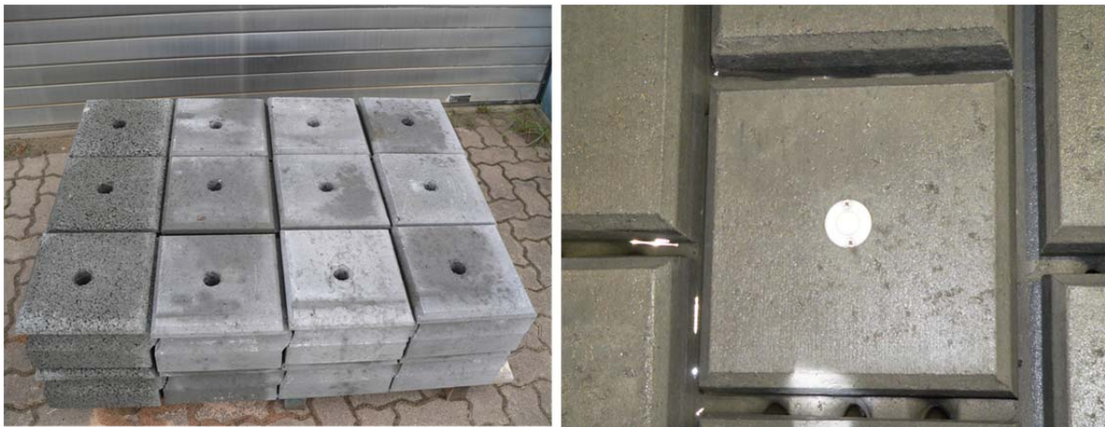
Abbildung 4.3: aufgebohrte Verkalit®-Deckwerksteine 180 mm ohne modifizierte Feder und Öffnung (links); Verkalit®-Deckwerkstein mit eingesetzter Druckmessdose
