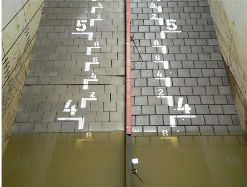
Abbildung 8.1: links: Abschnitt 2 (Pflasterstein 180°mm nach DIN EN 1338) mit deutlich erkennbaren Setzungen bzw. Hebungen im Bereich des Ruhewasserspiegels von 4,5 m; rechts: Abschnitt 1 (Standard Verkalit®-Deckwerkstein 180°mm) mit unveränderten Fugenbild
