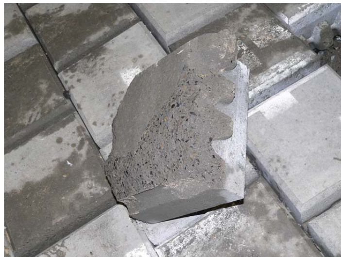
Abbildung 8.38: Materialversagen infolge des Ausziehversuchs des modifizierten Verkalit®-Deckwerksteins 180°mm 19 N
