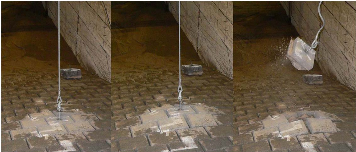
Abbildung 8.20: zeitlicher Ablauf des Ausziehversuchs des haufwerksporigen Verkalit®-Deckwerkstein 19-N in der Modellphase 2, Abschnitt 2
