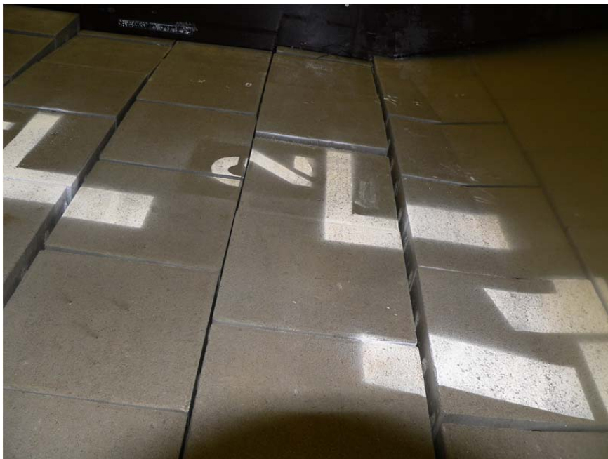
Abbildung 8.2: Veränderung der Längsfuge des Pflastersteins 180°mm nach DIN EN 1338 infolge der Belastung des Deckwerks mit dem Wellenspektrum JONSWAP 7
