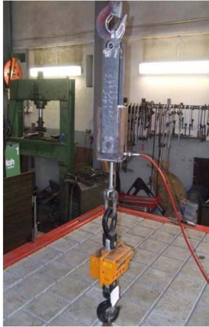
Abbildung 8.37: Ansicht des Rahmens mit Anhängervorrichtung, Hydraulikzylinder und Waage (STEGMAIER, 2010)
