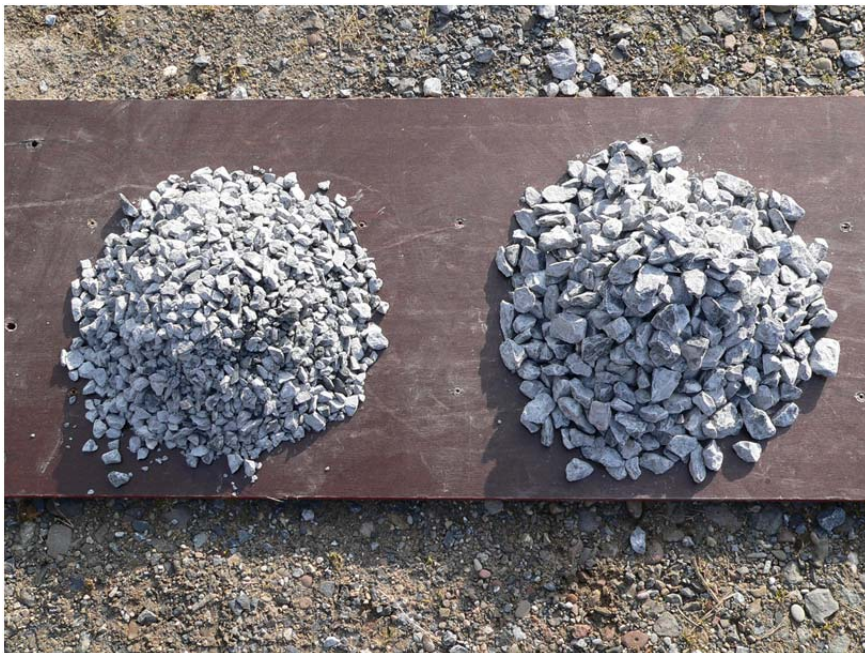
Abbildung 2.12: devonischer, tektonisch kaum beanspruchter Massenkalk mit einer Körnung von 2-16 mm (links) und mit einer Körnung von 16-32 mm (rechts)
