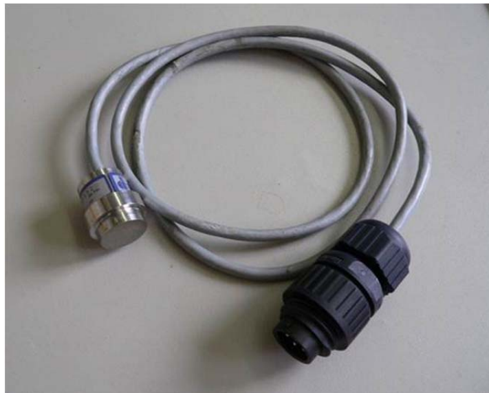
Abbildung 4.2: eingesetzte 5bar Druckmessdose zur Bestimmung des Drucks an der Deckwerksoberfläche
