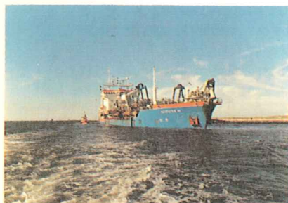
Het onderhoudsbaggerwerk aan de toegangseulen voor de havens gebeurt met zelfvarende zandzuigers, die het opgezogen zand ook naar de plaats van bestemming brengen. Met dezelfde werktuigen kan een deel van de suppleties worden uitgevoerd.
