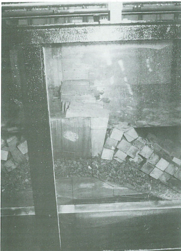
9 Detail schade kruinelement, proef T33
