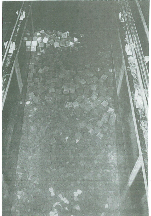
13 Schade na proef T45
