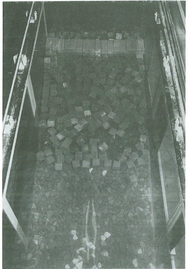
11 Schade na proef T39
